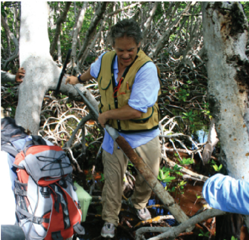
Figura 1. Extracción de muestras de suelo para determinar existencias de carbono en manglares.
