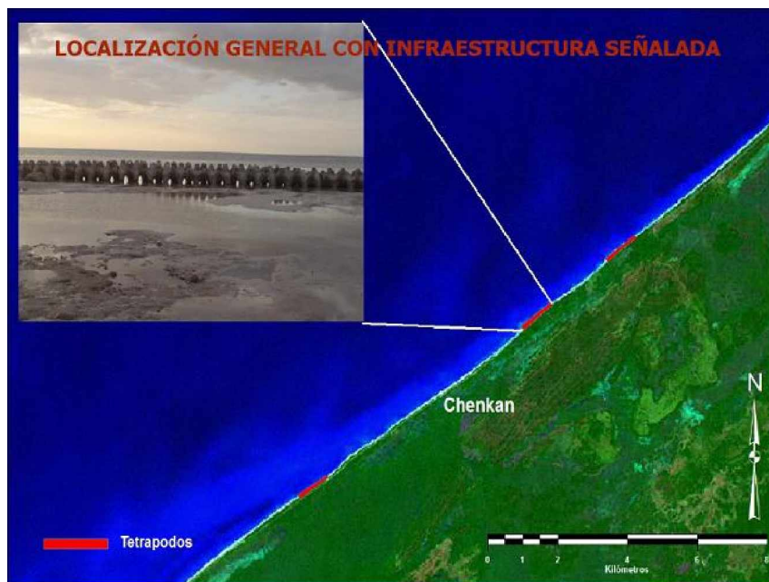
Figura 4. Zonas de colocación de tetrápodos en el área de Chenkan, Campeche.
