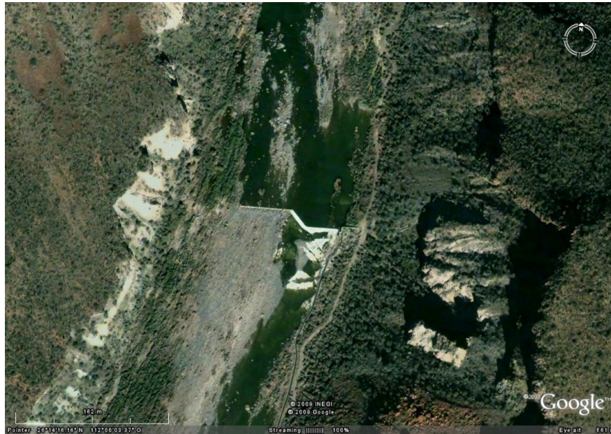
FIGURA 32. IMAGEN DE SATÉLITE DE DIGITAL GLOBE (2008) DE LA PRESA SAN ISIDRO CON UN VOLUMEN MÁXIMO ESTIMADO DE 37500 M 3 .
